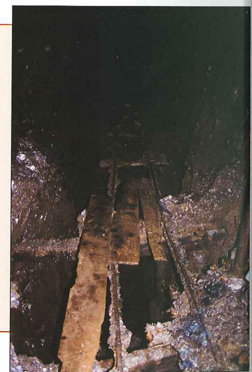
Dans le filon de Sainte-Barbe des rails enjambent un puits. On remarque des taches de couleur verte, signes de la présence du cuivre.
